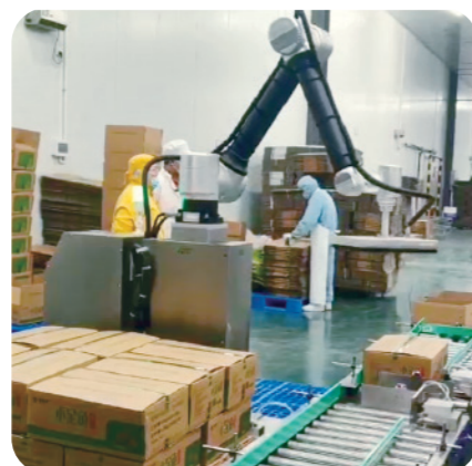
Công nghiệp hoá chất Xếp hàng cho sản phẩm giặt và sản phẩm chăm sóc Daily chemical industry Stacking of washing and care products load: 20~40kg 8~12 boxes/minute
