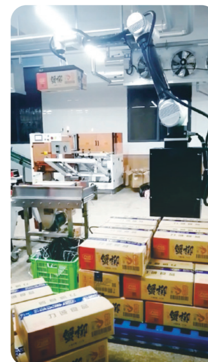
Ngành dược phẩm xếp chồng cho sản phẩm thuốc túi chất lỏng The pharmaceutical industry Stacking of liquid medicine bags load: 20kg 8-12 boxes/minute
