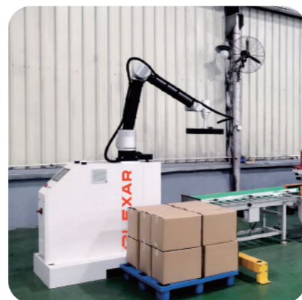
Ngành in ấn Xếp chồng cho các sản phẩm hộp màu Printing industry Stacking of color box products load: 20~30kg 8-12 boxes/minute
