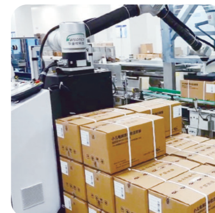
Ngành dược phẩm xếp chồng cho sản phẩm thuốc túi chất lỏng The pharmaceutical industry Stacking of liquid medicine bags load: 20kg 8-12 boxes/minute
