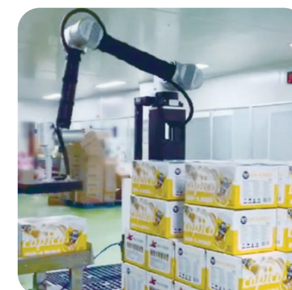
Ngành dược phẩm xếp chồng cho sản phẩm thuốc túi chất lỏng The pharmaceutical industry Stacking of liquid medicine bags load: 20kg 8-12 boxes/minute
